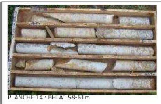
Figure 7: Sondage BHRA-1- Rive Droite-Calcaire Marneux Crétacé
