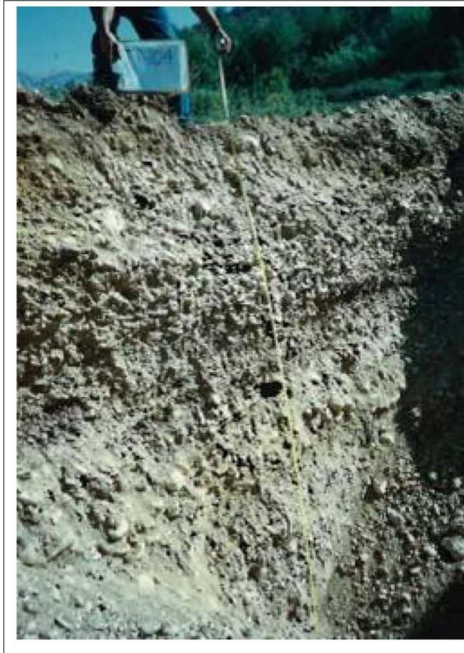
Planche 13: Contrôle En 2014. Aspect Des Argiles Intercalées Au Sein Des Graviers Sableux
